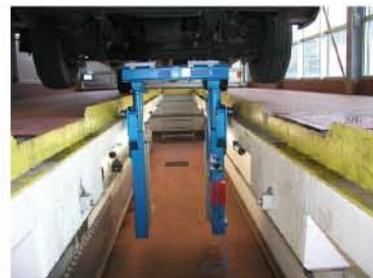
Ce cric permet un passage dans la fosse sans obstacle, un levage équilibré sans souci de glissement et un soutien permanent par un type de chandelle enchâssée dans le berceau.
